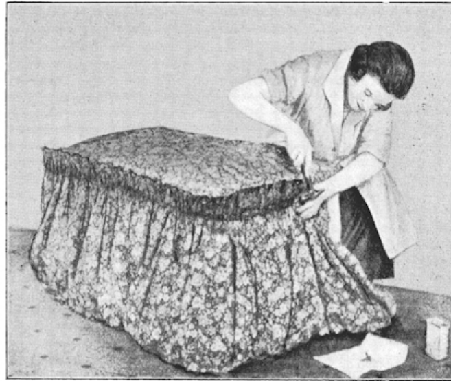
Nog even de buitenbekleding vastspijkeren.
